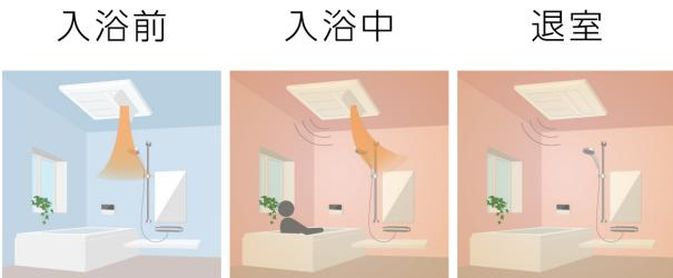
浴室が30°Cになるよう立ち上げ運転。▶ 浴室の温度を30°Cに調整。▶ 運転を停止。乾燥や換気も風向きも自動で制御。
