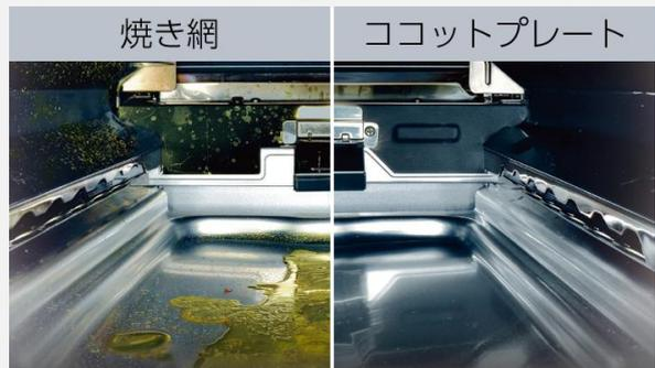
\*1 試験方法:「焼き魚」「ココットプレート」にてさんま 2 尾を調理し、調理後グリル扉を閉めたまま 30 秒間放置。グリル庫内各お手入れ部品(焼き網・ココットプレートは除く)への飛び散り量を 5 回測定し平均値を算出。焼き網はオートグリル(姿焼 標準モード)ココットプレートは(ココットプレート 焼き魚 強めモード)で調理。当社調べ。
