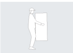
軽量・コンパクトなため 設置作業員一人で運搬可能
