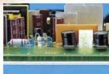
精密な制御機能を守るため、電気回路部分には雨・風・虫を防ぐように、ウレタン樹脂でモールドしています。
