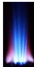
水素100%での燃焼実験 (水素は目視できないため少量のメタンを配合)
