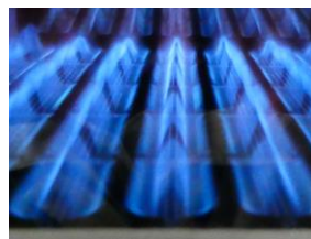
水素20%混合ガスの燃焼実験
