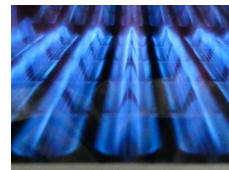
水素20%混合ガスの燃焼実験写真
