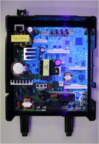
給湯器の電子ユニット
