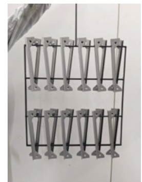
塗装ライン コンロ部品の掛け姿 (大口工場)
