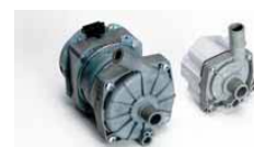
暖房ポンプ 0.55kgのコンパクトDCポンプを採用（従来ACポンプは2.4kg）耐久性を確保し、暖房能力にマッチングした新型ポンプ。消費電力も約53%低減。
