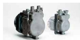
ふろポンプ 業界初の重さ0.75kgの高性能DCポンプを採用（従来ACポンプは2.1kg）消費電力も約50%低減。
