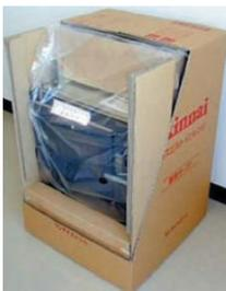
廃棄時等に問題となる発泡スチロールの削減のために、少量で大きな緩衝効果が得られる形状の研究や、商品の軽量化・高剛性化による緩衝材への負担の軽減などにより、段ボール材のみによる梱包を推進しています。現在、ユッコV・ユッコUFV・BFふるがま等の給湯器に引き続き、厨房器のビルトインコンロ等をスチロールレス梱包に切替えています。又、客先の要求に応える為に、リターナブル梱包等の検討も進めています。
