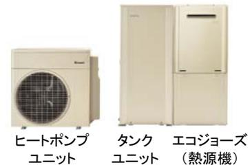
ECO ONEは、ヒートポンプユニットで取り入れた空気中の熱を利用すると同時に、瞬間的に高能力な給湯を可能とするガス給湯器「エコジョーズ」を組み合わせた家庭用のハイブリッド給湯・暖房システムです。家庭で使われるエネルギーの約半分を占める給湯・暖房分野で優れた省エネ効果を発揮し、省エネ住宅の推進に貢献します。
